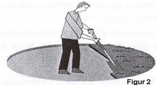
Mit einer Latte (idealerweise eine Messlatte), auf die Sie eine Wasserwaage aufsetzen, beginnen Sie nun, vom tiefsten Punkt ausgehend, Ihren Aufstellplatz einzuebnen. Graben Sie die erhöhten Stellen ab. Füllen Sie keinesfalls die Tiefstellen auf, da dies zu Setzungen führen könnte. Ebenen Sie nun den Aufstellplatz so lange ein, bis dieser vollkommen eben ist. Ein ordnungsgemäß vorbereiteter Aufstellplatz ist Voraussetzung für eine problemlose Montage Ihres Schwimmbeckens. **Figur 2.**
